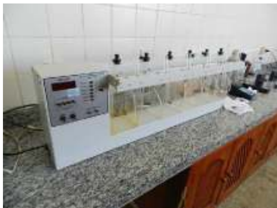
Figura 48- Aparelho Jar Test
