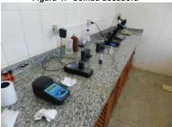
Figura 49 - Aparelhos de bancada - fotocolorímetro, Phmetro, turbidímetro, colorímetro, e balança
