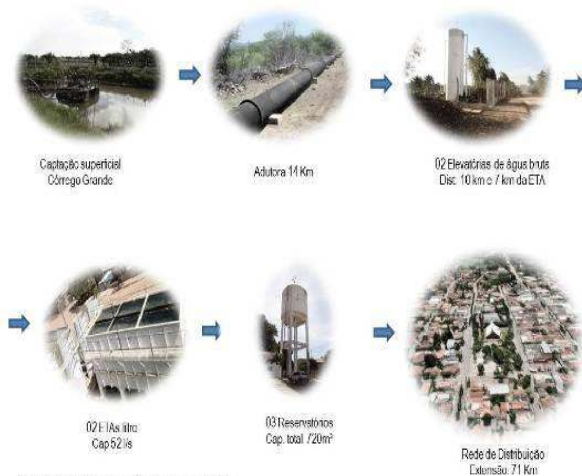
Figura 21 - Esquema do Sistema de Abastecimento de água da área urbana.
