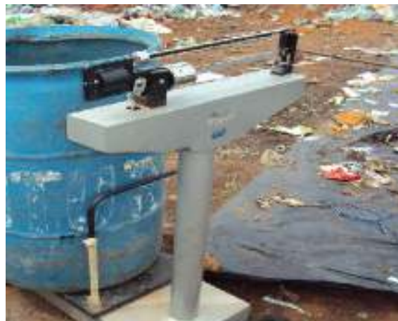
Figura 39 - Balança e Tambor com capacidade de 200L para pesagem das amostras (PGIRS, 2013).
